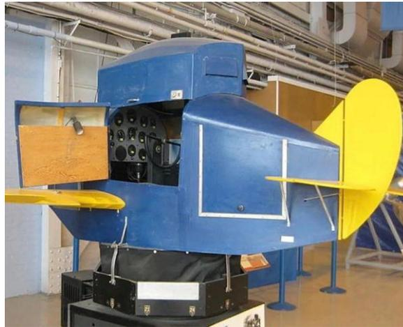
**Figure 23: Simulateur de vol développé par Edwin Link<sup>50</sup>.**
