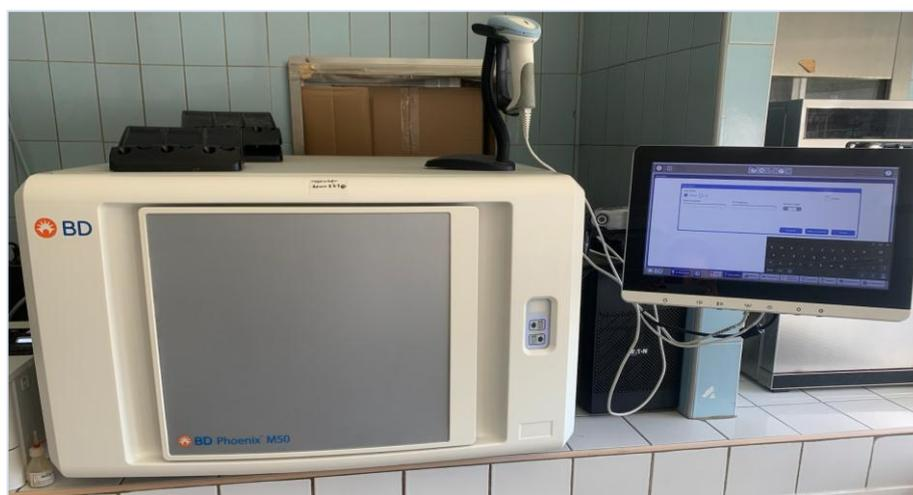
**Figure 9 : L'automate d'analyse BD Phoenix M50**
