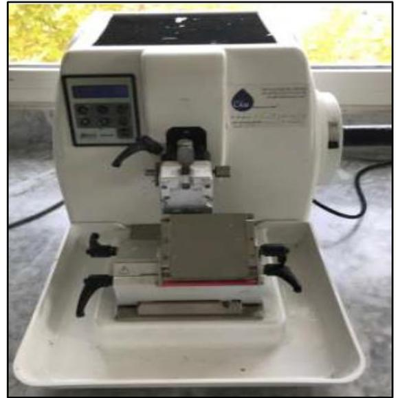
Figure N°8 : Microtome rotatif semi-automatique AEM 450(Réf : laboratoire d'anatomie et cytologie pathologiques, CHU FES)
