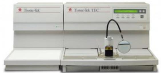
Figure N°6: Console d'enrobage des tissus « Tissue-Tek® TEC™ 5 » (Réf : laboratoire d'anatomie et cytologie pathologiques, CHU FES).
