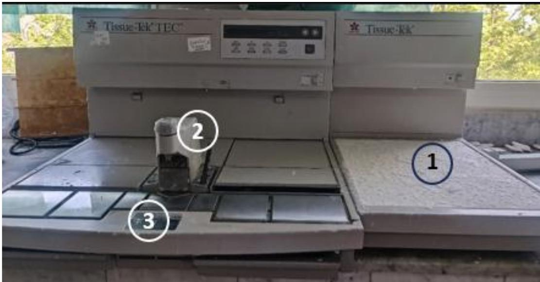
**Photo N°15** : Station d'enrobage ; 1/ plaque froide, 2/ distributeur de paraffine, 3/ spot froid (Réf : laboratoire d'anatomie et cytologie pathologiques, CHU FES).
