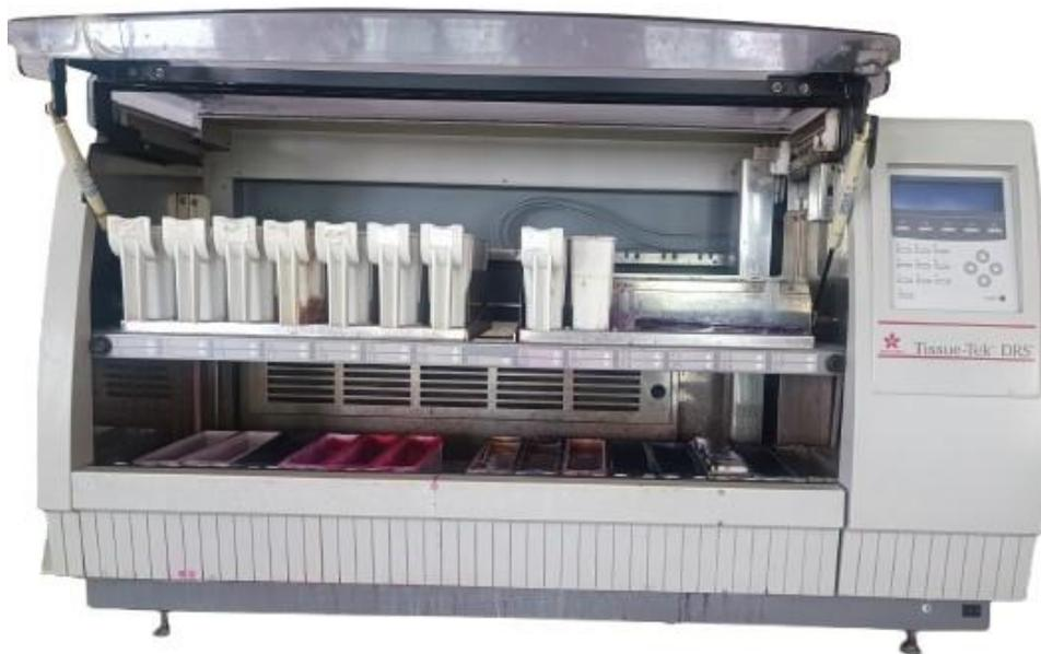
**Photo N°20** : Automate de coloration de lames Tissue-Tek® DRS™ 2000(Réf : laboratoire d'anatomie et cytologie pathologiques, CHU FES)
