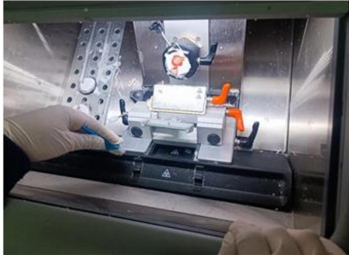
**Photo N°53 :** réalisation de coupes à congélation dans un microtome cryostat rotatif (Réf : laboratoire d'anatomie et cytologie pathologiques, CHU FES).
