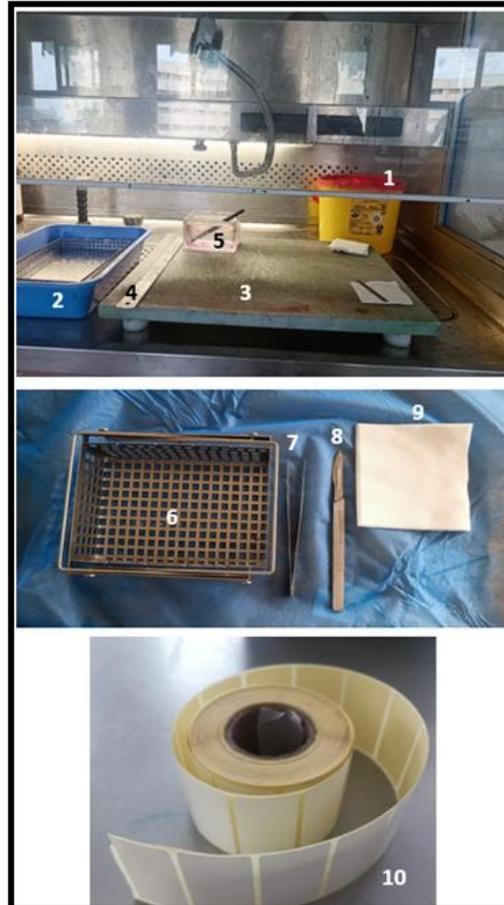
**Photo N°29 :** Matériels de la table de macroscopie, 1/ récipient objets tranchants, 2/bac à formol, 3/planche à découper, 4/règle, 5/cuvette, 6/portoir, 7/pince, 8/ manche et lame de bistouri, 9/compresses, 10/ruban d'étiquettes (Réf : laboratoire d'anatomie et cytologie pathologiques, CHU FES).
