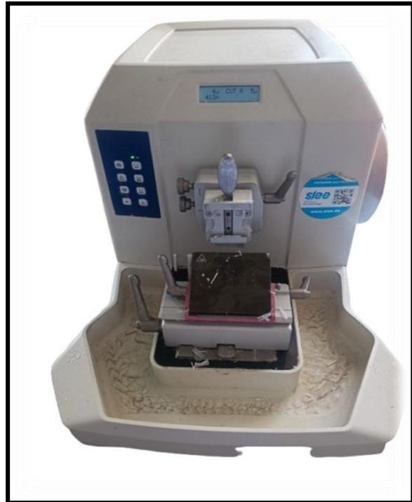
**Photo N° 16 :** Microtome rotatif semi-automatique AEM 450 (Réf : laboratoire d'anatomie et cytologie pathologiques, CHU FES)
