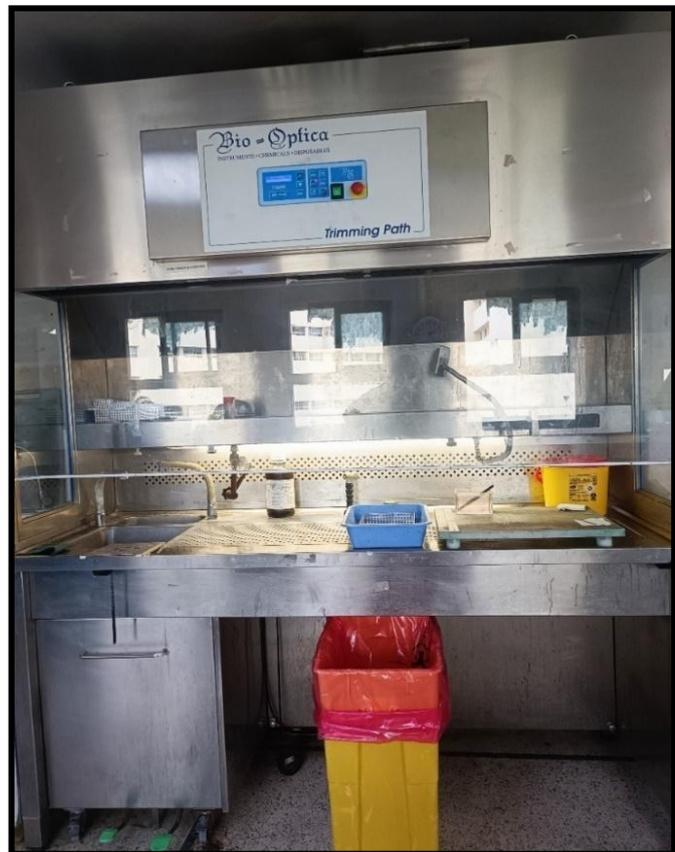
**Photo N°12** : Hotte d'aspiration "trimming path, Bio optica", (Réf : laboratoire d'anatomie et cytologie pathologiques, CHU
