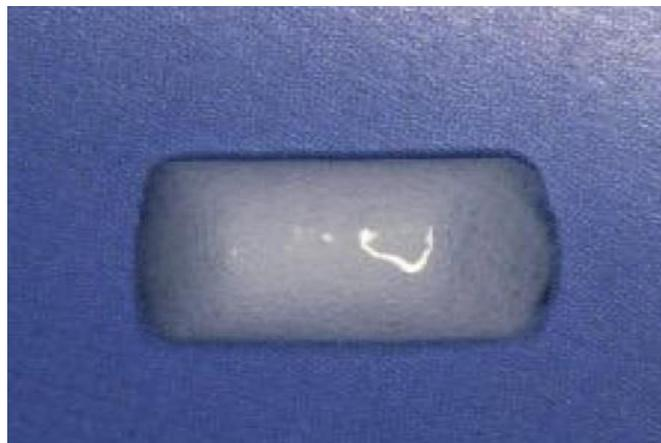
**Figure 11 [7]** : Eponge en silicone expansé siliconée de forme ovale et biseautée
