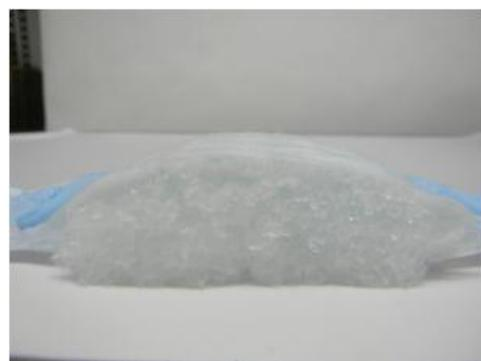
**Figure 7 Bis: Gel super absorbant après exposition à l'humidité**
