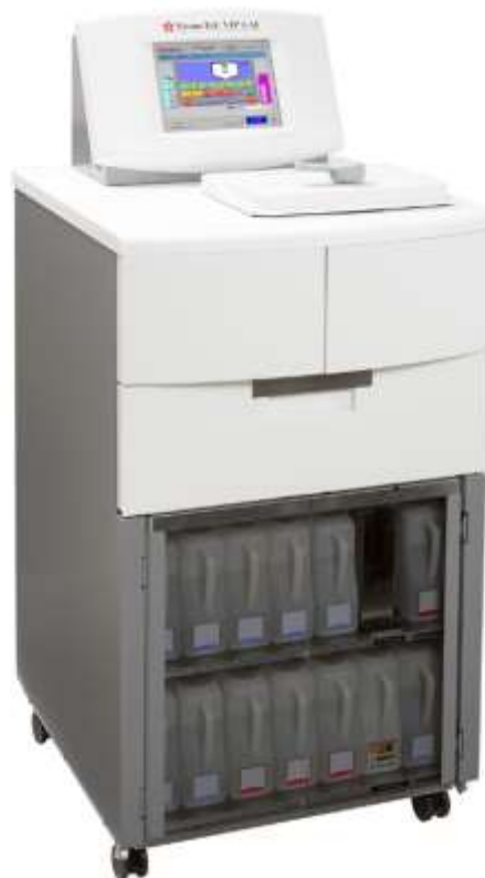
Figure 5: Automate à inclusion sous vide Tissue-Tek VIP® 6 AI disponible au service
