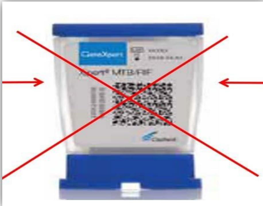
**Figure 19 : Exemple d'étiquetage non conforme de la cartouche (14)**
