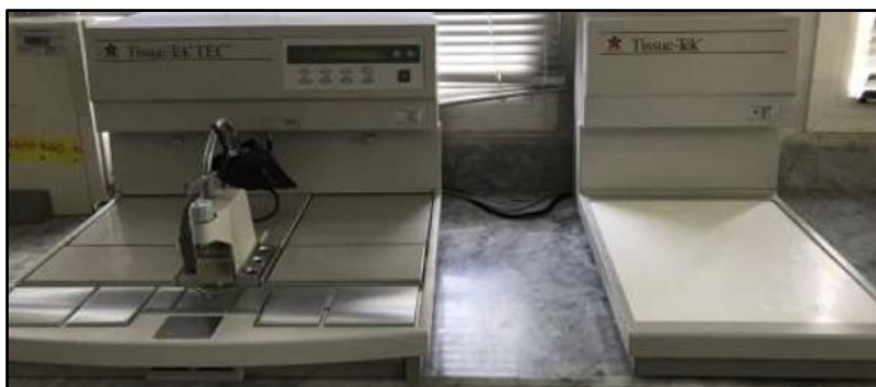
Figure N°4: Console d'enrobage des tissus « Tissue-Tek® TEC™ 5 » disponible au service.
