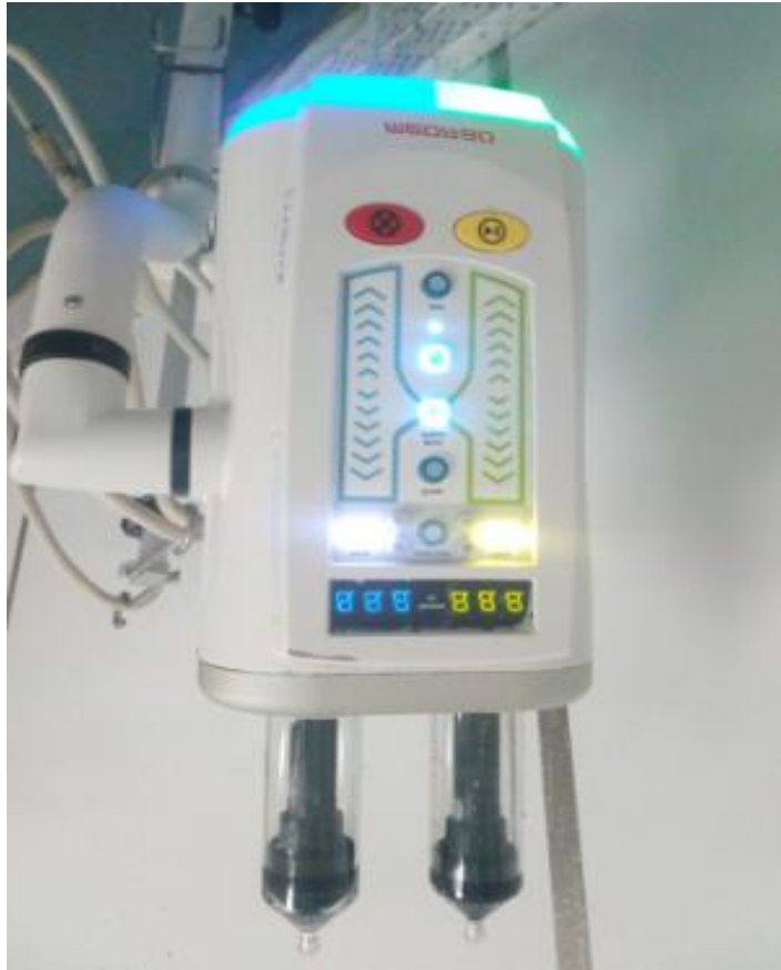
Figure. 12 : Injecteur automatique du scanner
