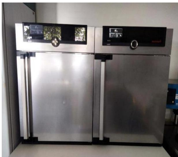
Figure 2. Etuves (30°C et 37 °C) pour incubation des cultures– laboratoire de parasitologie–mycologie du CHU Hassan II de Fès.
