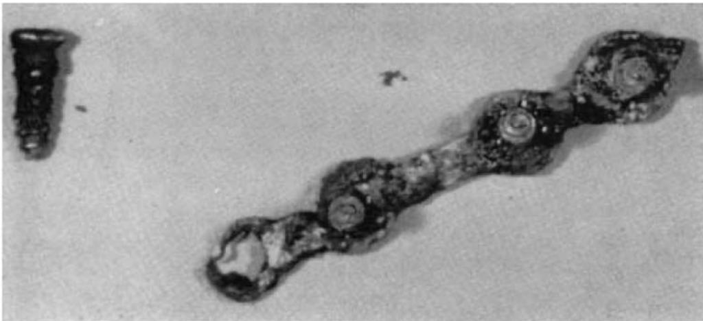
Figure 6. La plaque de Lane a été abandonnée à cause de la corrosion (1895).
