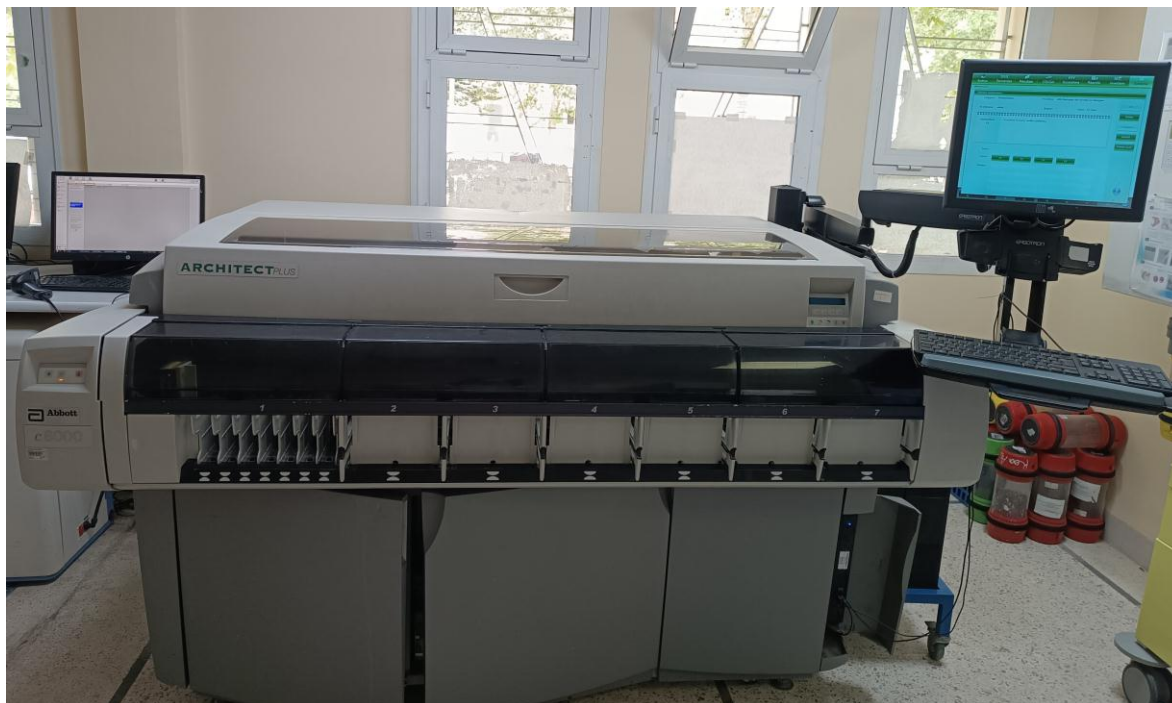
Figure 8 : Automate de dosage de la ferritine sérique « ARCHITECT plus c8000 » disponible au service.
