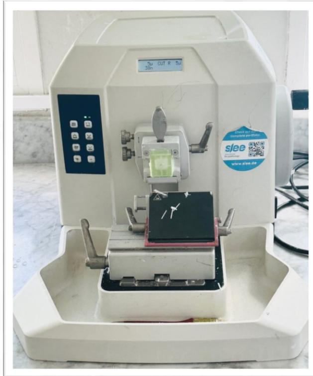
Figure 6 : Microtome rotatif semi-automatique.
