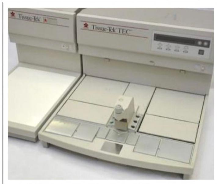
*Figure 5: Console d'enrobage des tissus « Tissue-Tek® TEC™ 5 ».*
