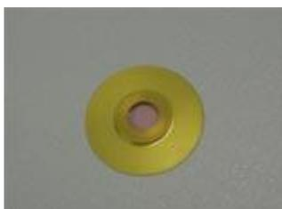
Figure 18 : Filtre à placer sur la caméra afin de ne pas l'endommager.
