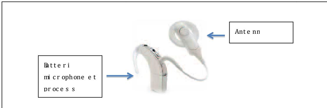
Figure 1: Partie externe d'un implant sans boîtier ; Marque Cochlear® (78-A)
