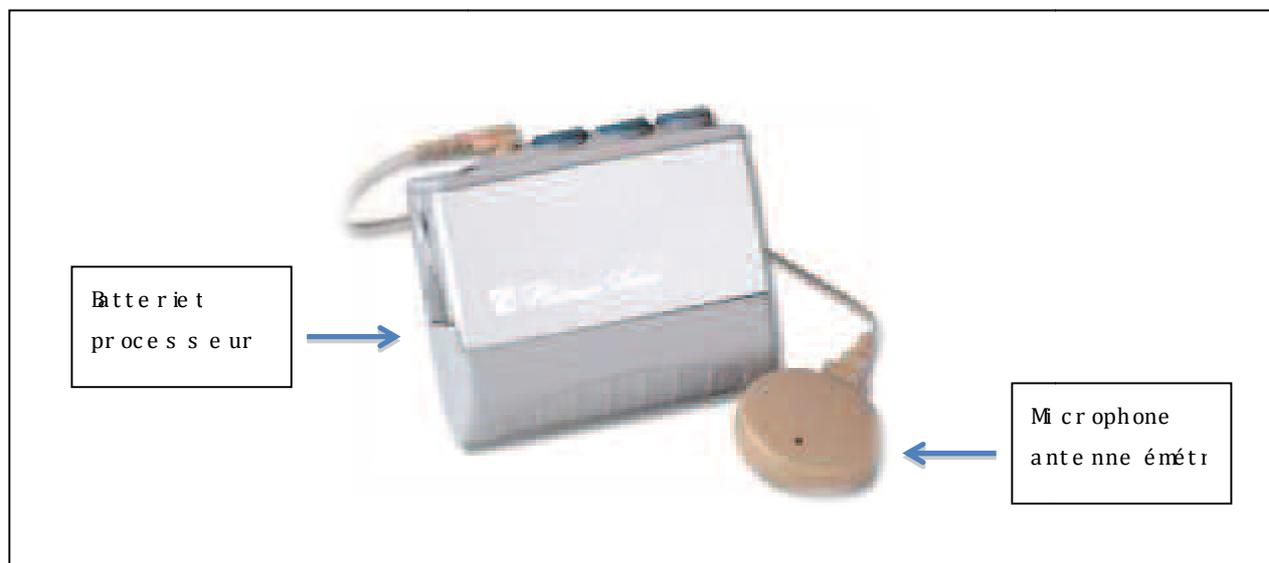
Figure 3: Partie externe d'un implant sans contour d'oreille ; Marque Advanced-Bionic®
