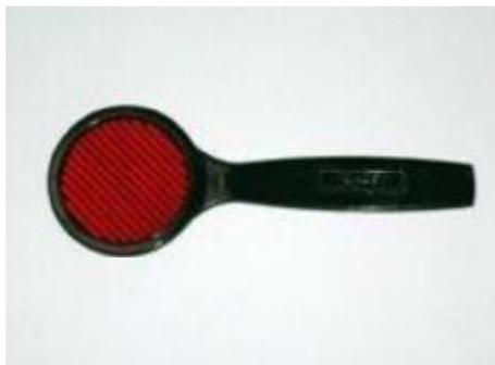
La baguette est munie un verre cylindrique ; si on le place devant un œil et on regarde au travers une source lumineuse, celle-ci est vue comme une strie lumineuse perpendiculaire à l'axe du cylindre; ainsi, pour rechercher :
