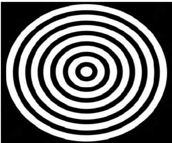
Figure 1. Exemple d'un profil obtenu à l'aide d'un disque de Placido.
