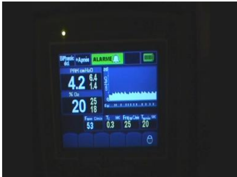
Figure 17 : Mode "BiPHASIC dcl" BiPHASIC déclenché + apnée
