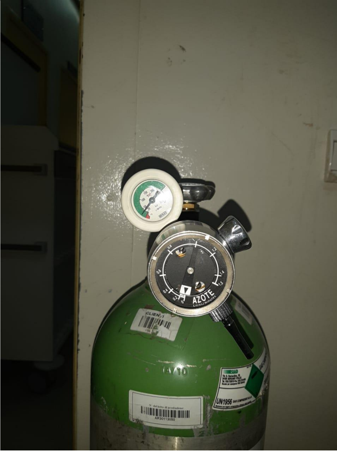
Image 1 : Illustrant le manomètre utilisé pour délivrer la dose de NO inhalé (iNO) de 0,2 à 1,5 litre par minute. Centre hospitalier universitaire HASSAN II, réanimation Mère-Enfant.
