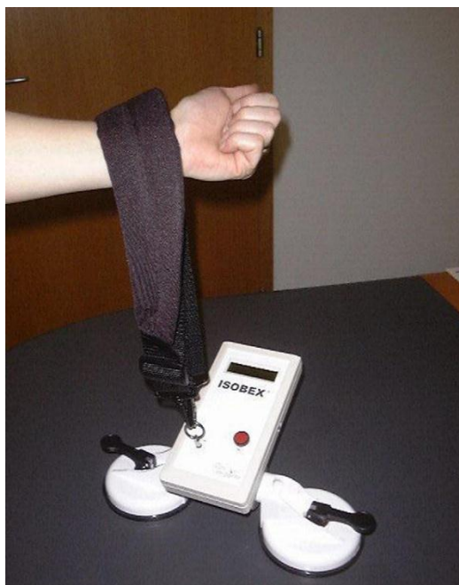
Figure 1 : Evaluation de la force à l'aide d'une balance. 6
