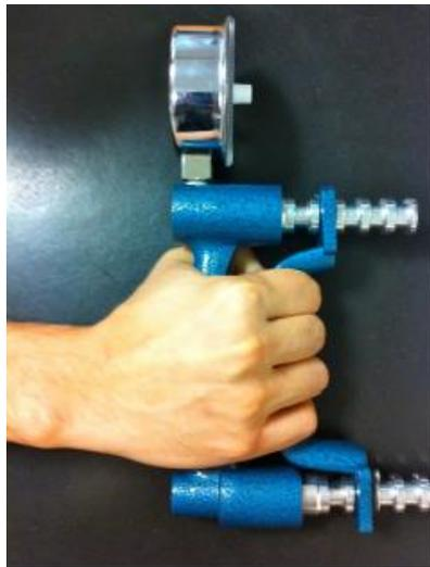
Figure 3 : Dynamomètre de Jamar®
