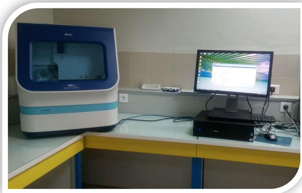
*Figure 11: Analyseur génétique 3500Dx.*
