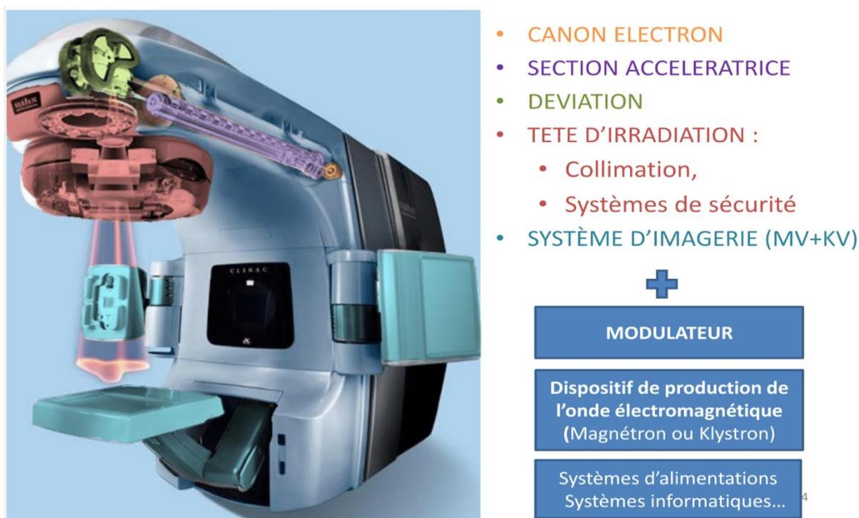
**Figure 19. Schéma explicatif montrant le principe de fonctionnement d'un LINAC « classique » et de ses différents composants.**
