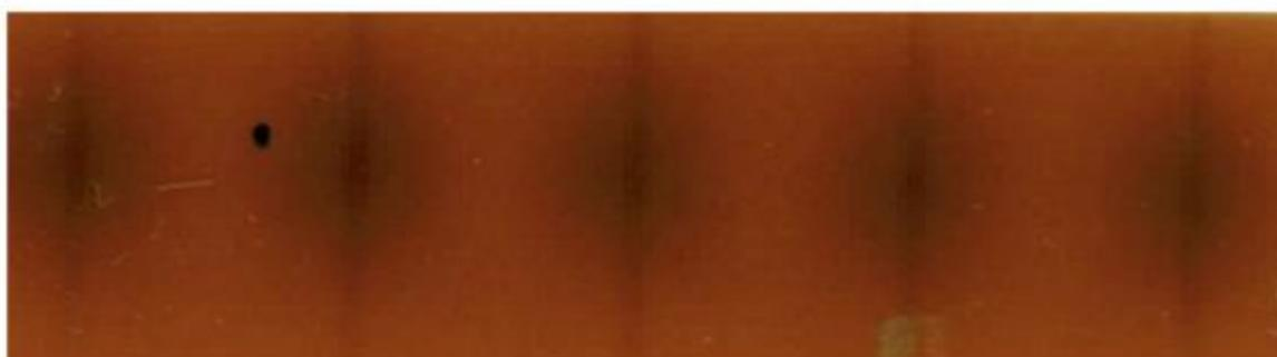
Fig. 4. Contrôle qualité de la précision du positionnement de la source par autoradiographie (pas de 5 mm).
