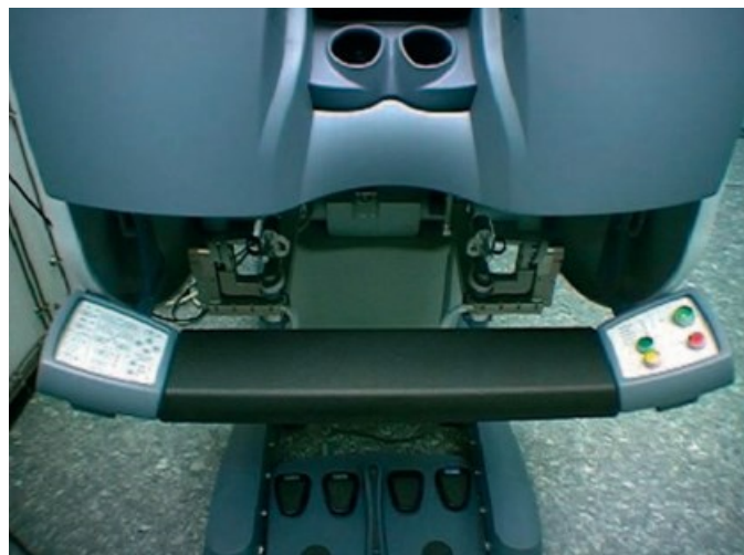
Figure 47. Instruments de commande da Vinci. Sous le cockpit se trouvent les joysticks de commande des instruments, et aux pieds les commandes de déplacement de caméra, de mise au point, de débrayage des instruments et de bistouri électrique.
