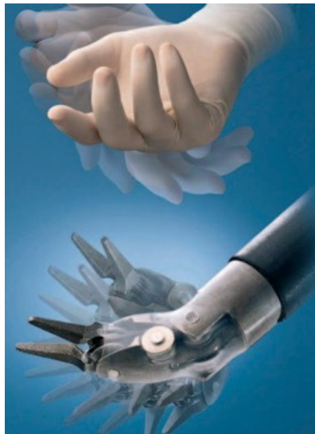
Figure 49. Instruments da Vinci. Les 7 degrés de liberté reproduisent ceux du membre supérieur humain.
