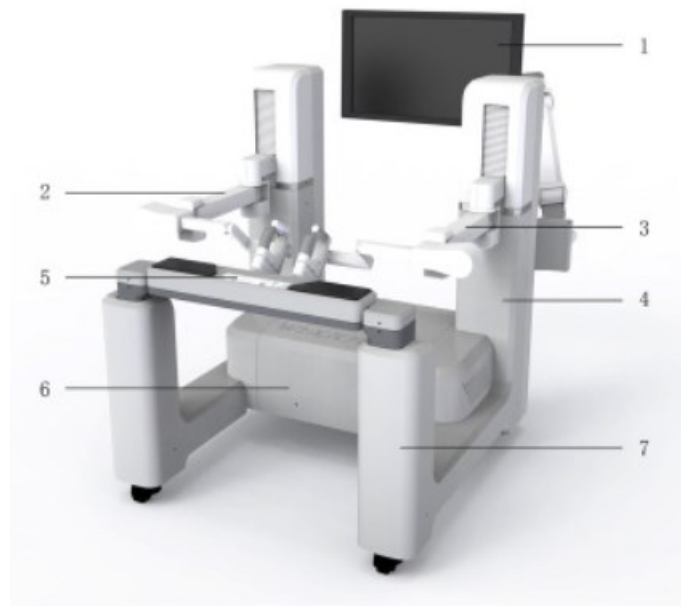
Figure 18 : .Console du chirurgien pour Micro Hand S. La console du chirurgien se compose des éléments : (1) dispositif d'affichage des images, (2) bras maître gauche, (3) bras maître droit, (4/7) colonne de support, (5) accoudoir, et (6) système de commande.
