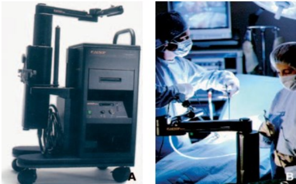
Figure 42. AESOP (Automated Endoscopic System for Optimal Positioning, Computer Motion puis Intuitive Surgical) : premier système assisté par robot utilisé pour tenir l'endoscope et commandé par la voix
