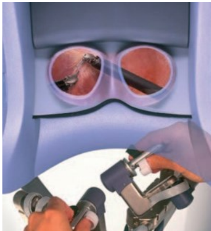
Figure 45. Système de vision da Vinci. Deux caméras tri-CCD fournissent une réelle vision en 3D. Les mains sont dans l'axe du regard, donnant l'impression au chirurgien de les plonger dans le champ opératoire
